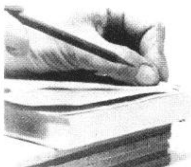
Рис. 16 Разметка шаблона для отстава
